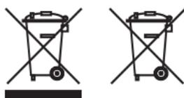
Символ у вигляді перекресленого смітника на колесах означає, що по закінченні терміну експлуатації електричне чи електронне обладнання разом із кабелями слід викидати окремо від побутового сміття. Старий пристрій можна безкоштовно здати на повторну переробку у пункт прийому або продавцеві, купуючи аналогічний новий пристрій.
